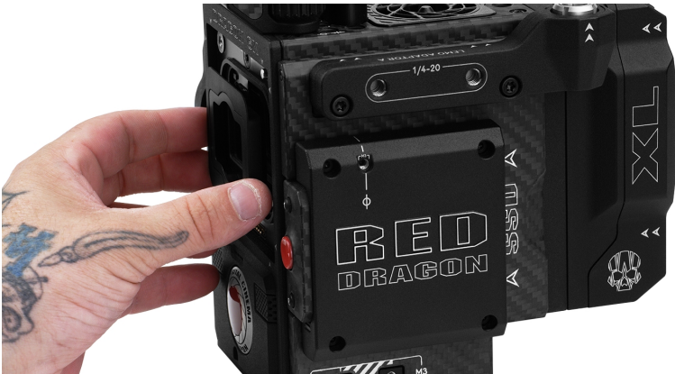
그림: 새 OLPF 모듈 설치
